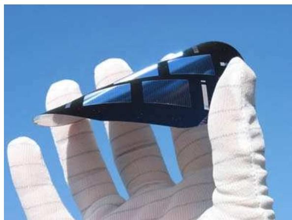
**Slika 11.** Sunčana FN ćelija izrađena tehnologijom tankog filma
