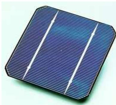
**Slika 6.** Sunčana fotonaponska čelija načinjena od monokristalnog silicijevog vafera
