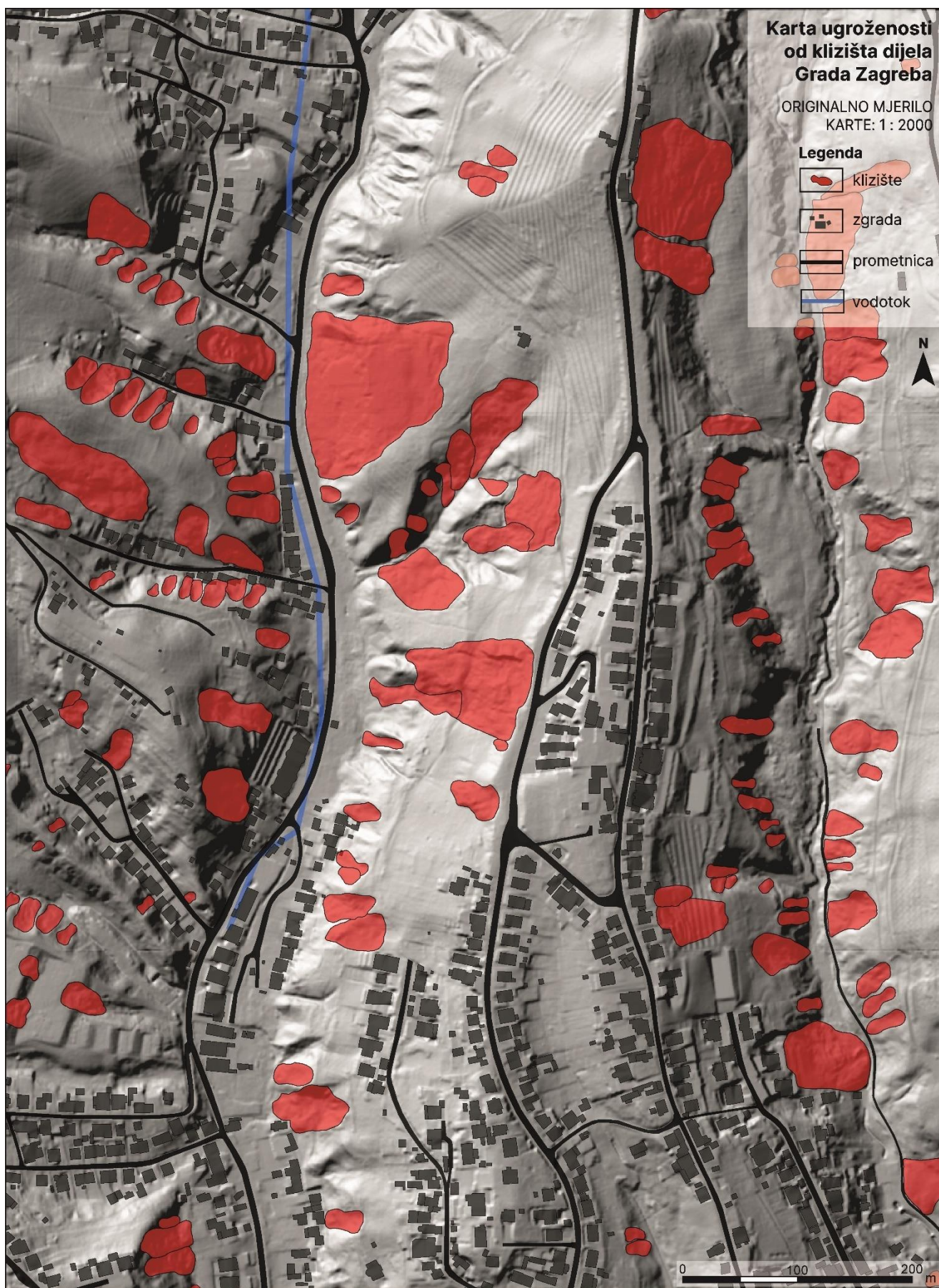
Slika 18 Isječak iz Karte inventara klizišta dijela Grada Zagreba mjerila 1:2000 s prikazom elemenata pod rizikom (zgrade, prometnice, vodotok)
